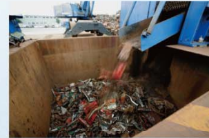
マウントシャーによる鉄の切断処理
