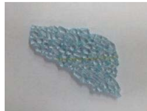
③剥離処理あと(熱線・糊剥離)
