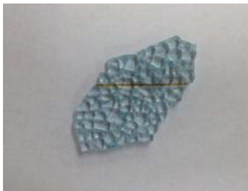
②剥離処理あと(熱線剥離)
