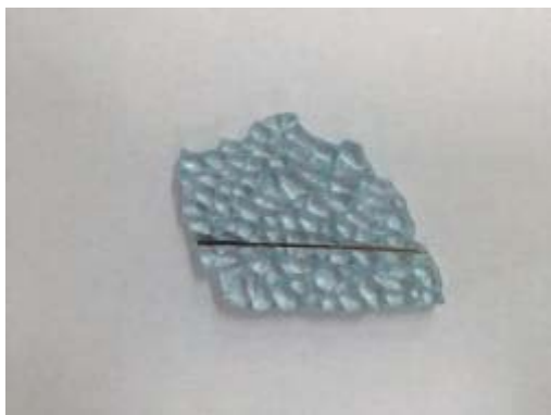
①剥離処理まえ(熱線有)
